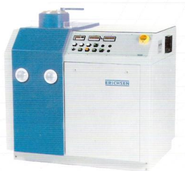
Rys. 2. Uniwersalna maszyna do badania blach i taśm firmy Erichsen, model 142-40
