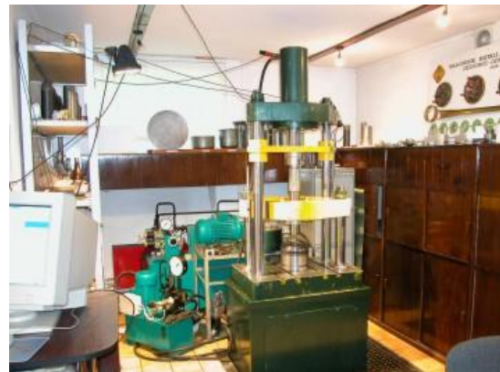
Rys. 1. Stanowisko badawcze do kształtowania blach – prasa hydrauliczna podwójnego działania ( 2 \times 600 kN)
