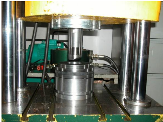
Rys. 1. Stanowisko badawcze do kształtowania blach – prasa hydrauliczna podwójnego działania ( 2 \times 600 kN)
